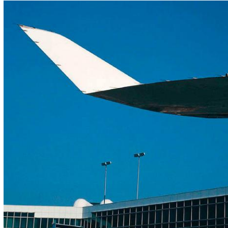
Winglet eines Flugzeuges
